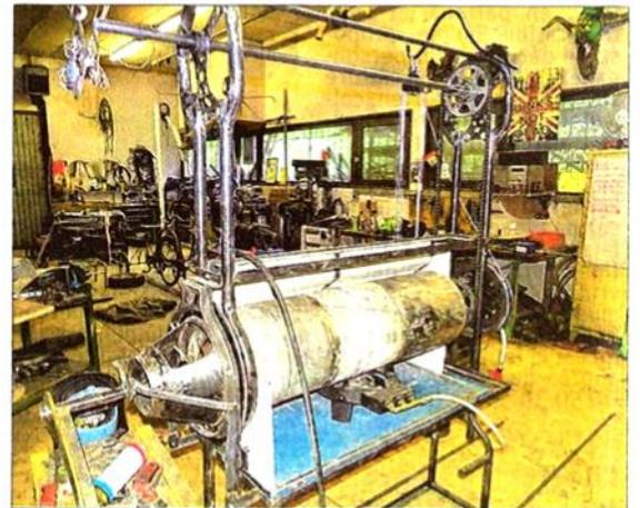
**En cours de finition au sein de l'atelier de la Toupine, ce four à châtaignes rotatif unique qui fonctionne au gaz a une capacité de 15 kg. Il sera utilisé par les bénévoles à la Tanière des Flottins. Photo Le DL/C.B.**
