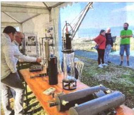
Les prélèvements d'échantillons d'eau à des grandes profondeurs sont réalisés avec du matériel sophistiqué : ainsi des bouteilles programmables et des sondes multiparamètres entre autres.
